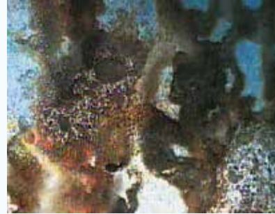
Korozyona uğramış Fin yüzeyinin mikroskop görüntüsü
